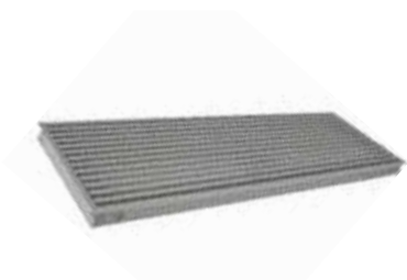
Grille de soufflage de sol 1000 x 75 mm pour 230 à 400 m 3 /h, ailettes fixes 15° aluminium anodisé
