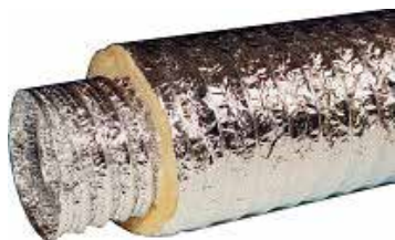
Gaine souple hygiénique M0/M1 en aluminium et polyester, isolé thermique et phonique, longueur 10m
