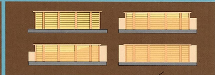
La structure autoporteuse permet une installation de la piscine en hors sol, semi-enterrée ou enterrée.
