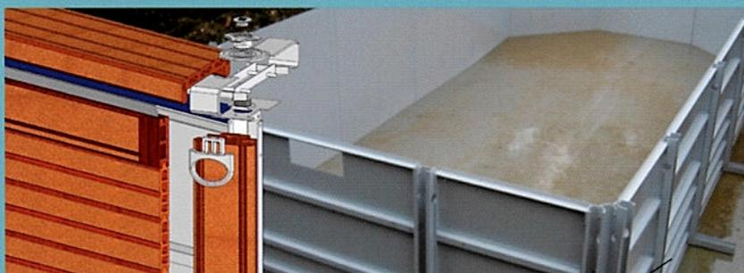
Une bride vient fixer les margelles grâce aux cavités creusées dans ces dernières. Ce système robuste et éprouvé offre une stabilité parfaite à la margelle.
